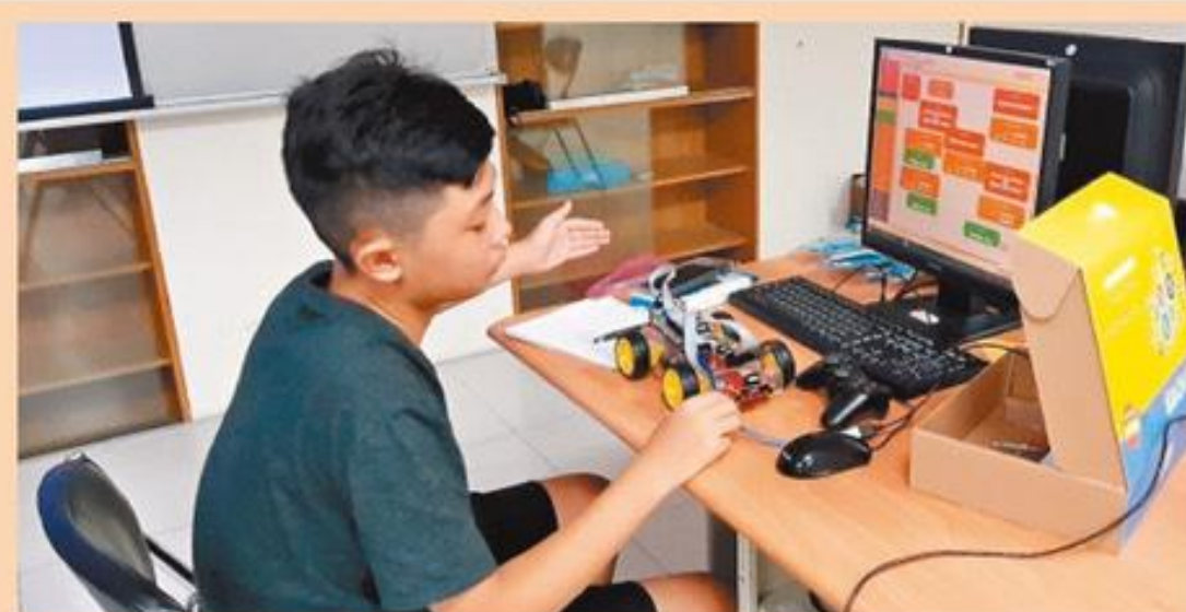
透過寓教於樂的方式，美樂璐小車組裝完後，再以TARKUS VP軟體編寫程式，讓使用者從零開始，建構出能照自己指令行動的車子。
